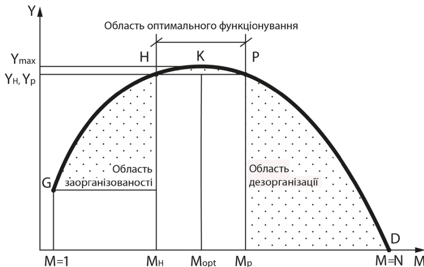
Рис. 1. Графічна інтерпретація залежності структурної інформації ( Y ) від кількості вільних станів ( M ) у системі з обмеженнями
