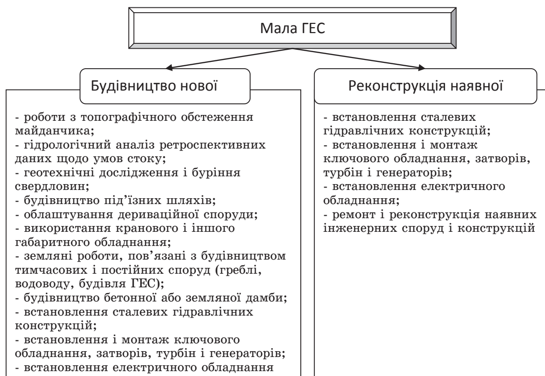
Рис. 1. Склад статей витрат, пов'язаних із будівництвом нової та реконструкцією наявної малої ГЕС
